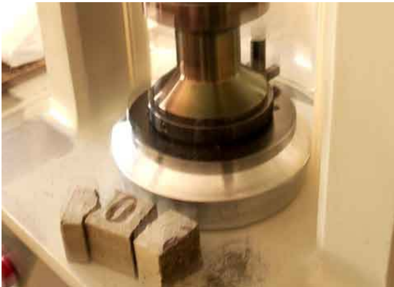
Test di rottura a compressione dei provini in malta plastica Testing compression strength of the standard mortar
