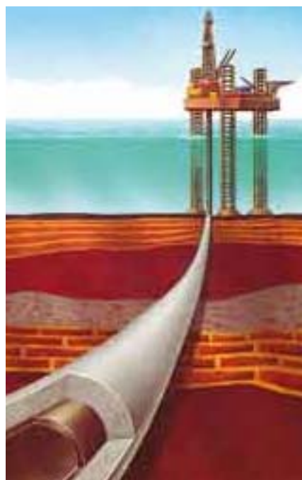
Pozzo petrolifero offshore cementato.
